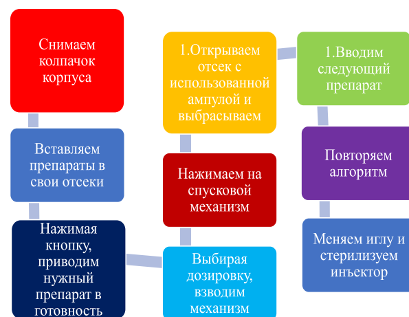
Рисунок 21. Алгоритм использования инъектора
